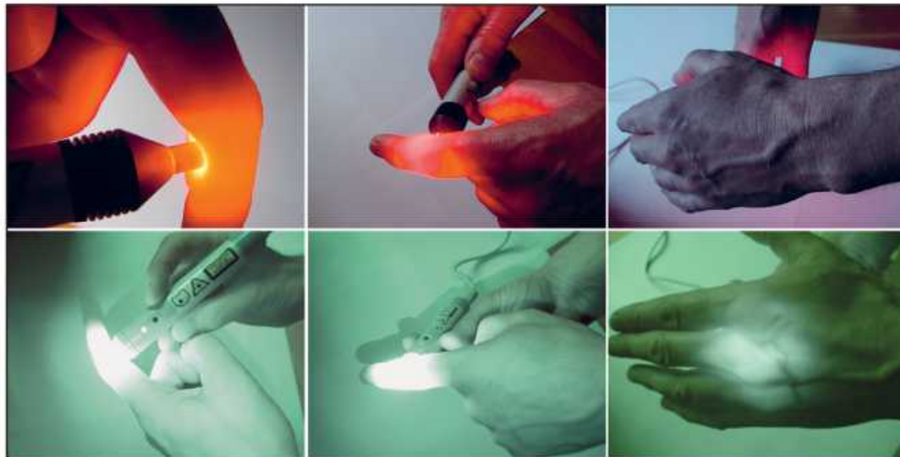
Bild 8: Rotes Laserlicht wird im Gewebe gestreut, teilweise absorbiert, aber auch an absorbierenden Strukturen (Knochen) vorbeigeleitet. Hier wird ein Finger von einem 250 mW starken roten Laser (660 nm), und einem 400 mW starken IR Laser (830 nm) bestrahlt. In der Handfläche ist kaum rote, wohl aber etwas IR Transmission sichtbar. Mit einem empfindlichen Messgerät liegt eine jeweilig emittierte Leistung bei etwa 0,002 mW/mm 2 (Finger rot), 0,012 mW/mm 2 (Finger IR), 0,00001 mW/mm 2 (Hand rot) und 0,0004 mW/mm 2 (Hand IR). Die IR Bilder sind mit einer Sony HDR-SR1E im (unbeleuchteten) Night-Shot Modus aufgenommen, die roten Bilder auch mit einer Sony DSC-H1. Hier erscheint elektronisch bedingt ein besonders helles rotes Licht orange bis gelblich.
